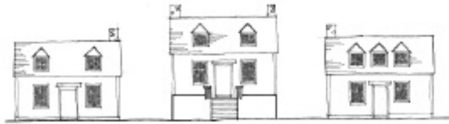
Fondation rehaussée exagérément
